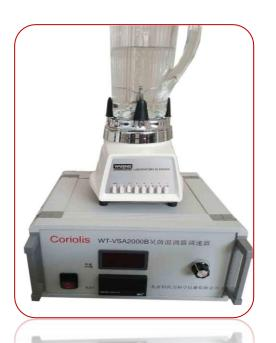
转速能够恒定不变。该吴茵混调器采用进口主机,转速能够达到 22000RPM, 具有电压和转速两种显示方式,适用于不同场合的需要。
