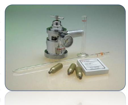
Fann 的半面积 API 失水仪的紧凑型,采用 1/2API 的过滤面积。时间和压力要求与 API 失水仪相同。根据美国石油学会"API 推荐规程 13B-1 和 13B-2"的规定,读数通过乘以 2 转换为标准测量值。
